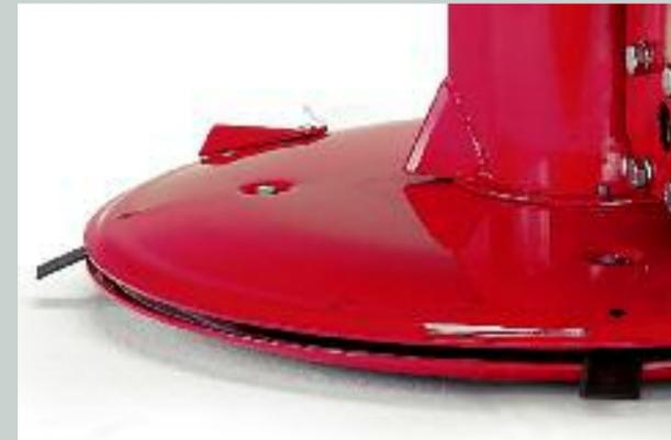
Il tamburo, dalla struttura semplice ma robusta, ha il disco inferiore "folle" che ruota liberamente, impedendo al disco di taglio di affondare nel terreno, il foraggio così ottenuto è di buona qualità in quanto privo di impurità.
