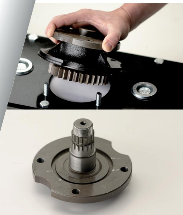
Ecco i vantaggi di una manutenzione rapida: si può procedere alla sostituzione dell'ingranaggio del disco, togliendo il disco ed il supporto, senza smontare tutto il gruppo falciante. I modelli con numero di dischi pari possono essere forniti con dischi a tre lame.
