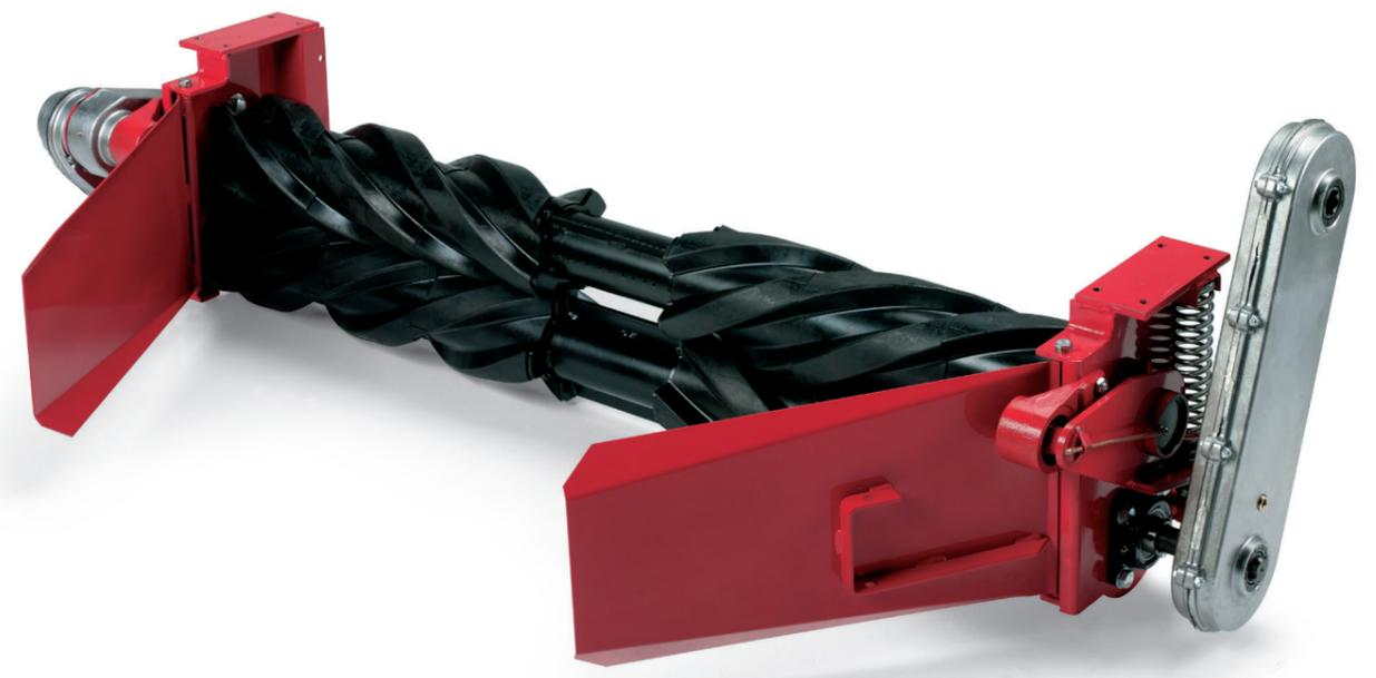
Per accelerare il processo di essiccazione e produrre un foraggio di ottima qualità le falciatrici sono accessoriate da un condizionatore con rulli in gomma elicoidali (tipo Chevron), dove entrambi i rulli sono trainanti grazie alla doppia trasmissione, in questo modo si elimina il rischio di ingolfamento.
