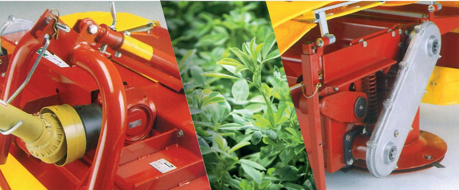
La falciatrice senza bombola di azoto è collegata al trattore in modo da lasciare tutta la testata libera di adattarsi all'andamento del suolo, aiutata dalle molle di alleggerimento che le permettono un'ampia capacità di oscillazione, condizione indispensabile per lavorare su terreni collinari e/o estremamente bagnati.
